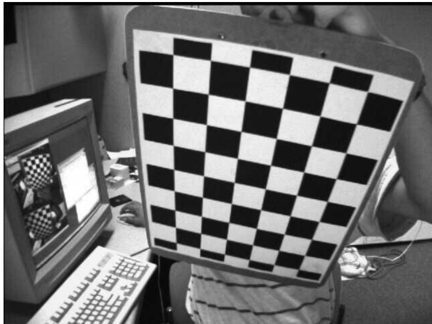
Figura 2.5: Esempio di pattern geometrico di calibrazione
