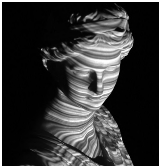
Figura 2.7: Utilizzo di un pattern più complesso per l'analisi di superfici
